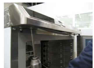
Desserrer les vis et retirer le couvercle pour accéder à la carte vidéo et le encodeur
