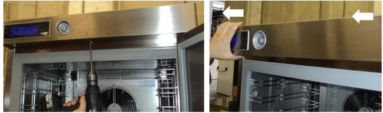
Desserrer les vis de la protection et la retirer le couvercle pour accéder la carte vidéo et le encodeur.
