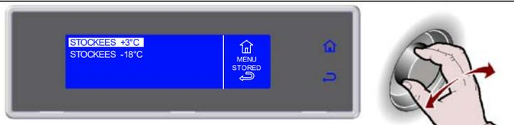
6. Appuyer sur la molette pour entrer dans la typologie de cycle sélectionné
