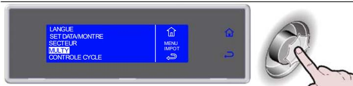
7. Sélectionner en tournant la molette le nombre de niveaux correspondant à l'appareil utilisé
