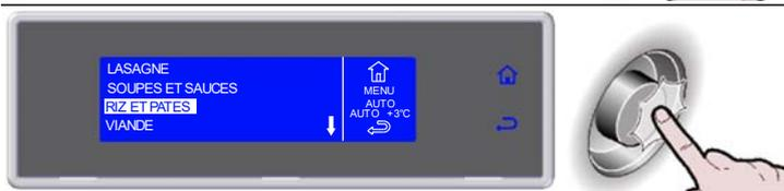
9. Sélectionner la quantité de charge à traiter, le minimum, la moyenne, le maximum
