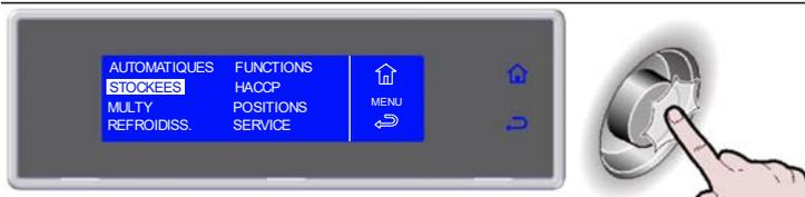
5. Sélectionner la typologie de cycle désiré en tournant la molette
