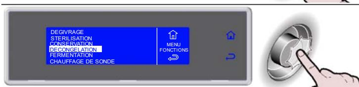
7. Sélectionnez en tournant le bouton la typologie la plus adapté au produit à traiter
