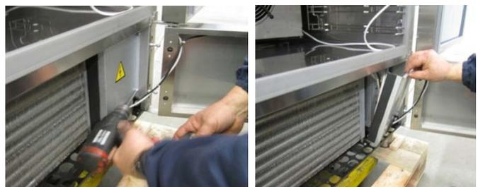
Retirer les vis de blocage du tableau électrique.
