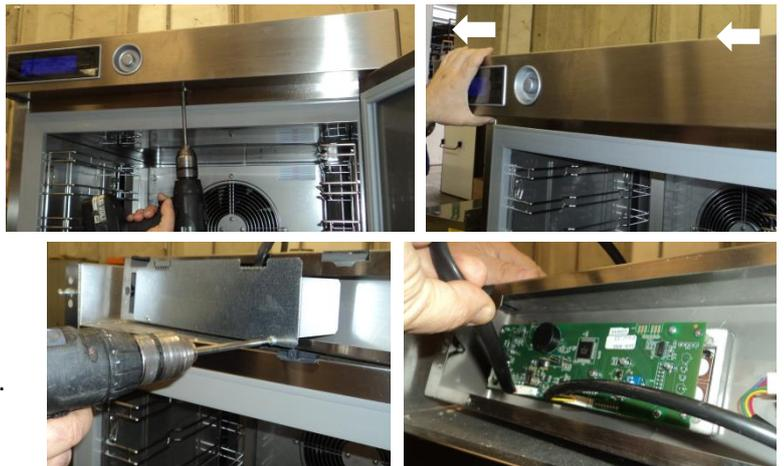
Desatornille los tornillos y retire la protección para acceder a la tarjeta de vídeo y a la encoder.
