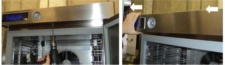
Lösen Sie die Schrauben und entfernen Sie die Abdeckung, um die Grafikkarte und den Encoder zugreifen.
