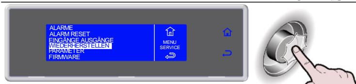
7. Passwort durch Drehen des Drehgriffs eingeben, zur Bestätigung des Werts Drehgriff drücken oder mit AUSFÜHREN fortfahren
