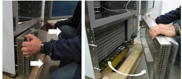
Schrauben des Verschlusspaneels entfernen.
