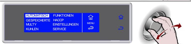
4. Drehgriff drücken, um Abschnitt AUTOMATISCH zu öffnen
